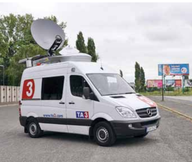
Obr. 9. Dvojkamerový spravodajský voz so satelitnou anténou
