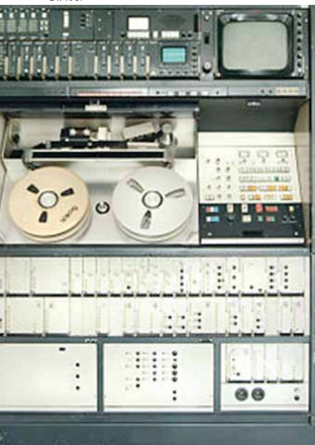
Obr. 3. Bosch VTR BCM quadruplexový dvojpalcový záznam nemeckej výroby
