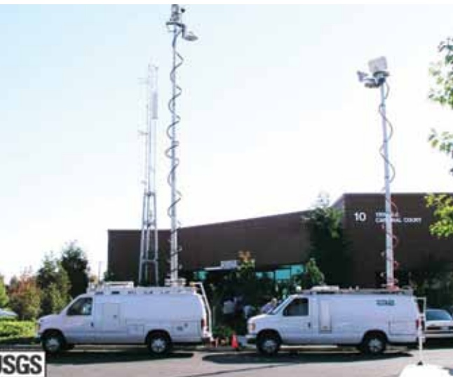
Obr. 8. Prenosové retranslačné vozy transportujú signál do televízneho centra
