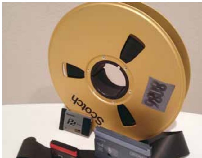
Obr. 1. Dvojpalcový quadruplexový videopás v porovnaní so súčasnými nosičmi
