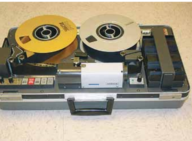
Obr. 2. Prenosný dvojpalcový záznam quadruplex VTR 3000 z r. 1967
