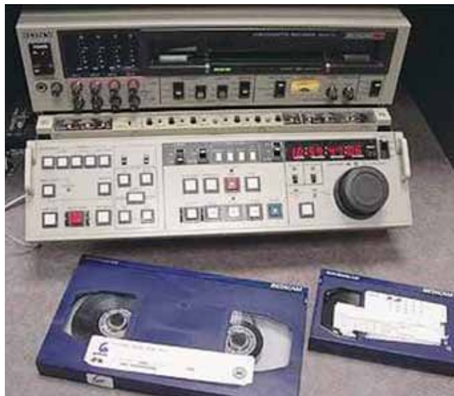
Obr. 4. Betacam SP polpalcový záznam s kazetami
